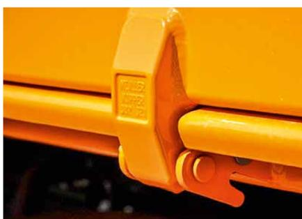
Integrierte Planenhaken am Kippbrückenboden
