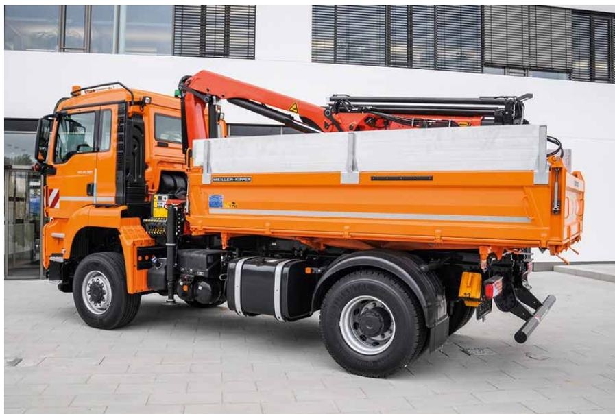
MEILLER Dreiseitenkipper Typ 9 mit Aluminiumaufsteckwänden und Vorbereitung für Ladekran
