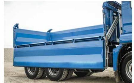
*Pendelnde und abklappbare Seitenwand mit Federentlastung*
