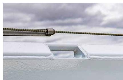
Die Bordwandzurrösen (2 t Zurrkraft) gewährleisten flexible Ladungssicherung.
