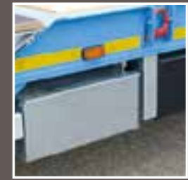
Steckerungen 50 x 100 mm mit Lagerung unter dem Fahrgestell
