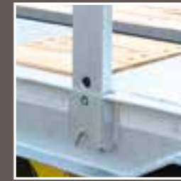
Steckerungen 50 x 100 mm mit Lagerung unter dem Fahrgestell
