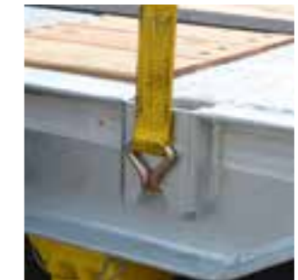
Rungentasche im Außenrahmen, Zurrpunkt LC 2.000 daN
