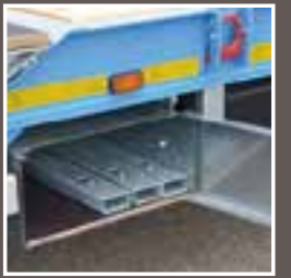
Steckerungen 50 x 100 mm mit Lagerung unter dem Fahrgestell
