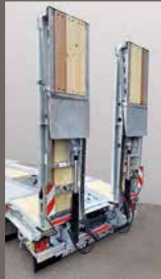
Doppelrampe mit hydr. ausstellbarem Spitzteil, Sperrzylinder ohne Rampenhaltegestänge
