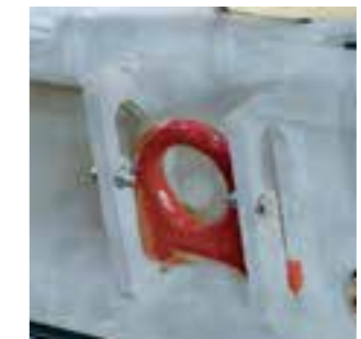
Zurring klappbar im Außenrahmen LC 10.000 daN
