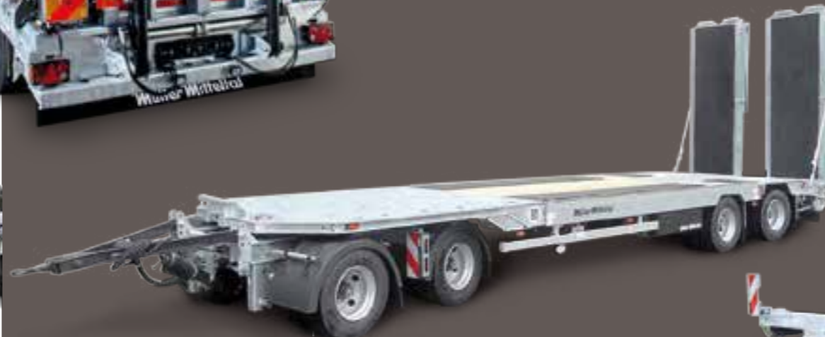
PT 40 Plateau-Anhänger mit hydraulischer Klappverbreiterung
