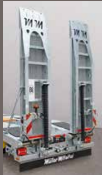
Einfachrampe mit Federheber
