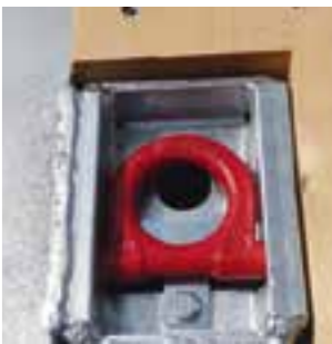
Zurring klappbar, versenkt LC 16.500 daN
