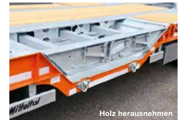
Radmulde abgedeckt, ebenes Plateau
