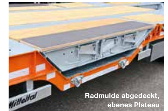
Große Radmulden zur Reduzierung der Ladehöhe zum Beispiel beim Transport schwerer Traktoren.
