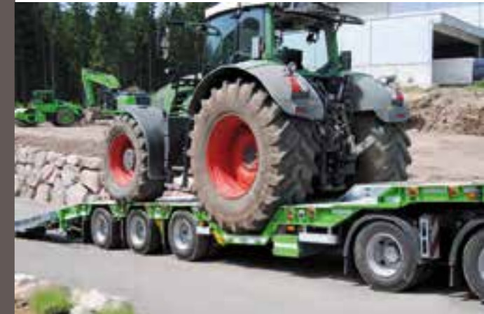
Große Radmulden zur Reduzierung der Ladehöhe zum Beispiel beim Transport schwerer Traktoren.
