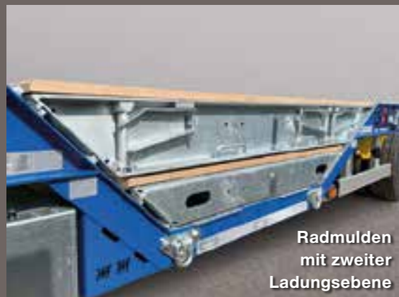
Doppelrampe mit hydr. ausstellbarem Spitzteil, Sperrzylinder ohne Rampenhaltegestänge
