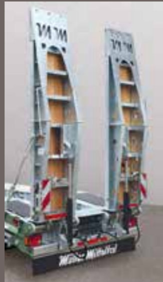
Einfachrampe mit Hydraulik
