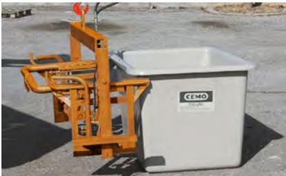
Einfahren des Ladebügels von der Seite nach dem Entfernen des abnehmbaren Deckels (Beispiel mit Streugutbehälter 700l)
