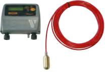
Füllstandsanzeiger für Öl, 230 V, zur kontinuierlichen Tankfüllstands-Verwaltung<br>Besondere Eigenschaften: kontinuierliche Messung, Anzeige des Füllstandes in Millimeter, Liter und Prozent, Mindest- und Höchststandsalarne mit potenzialfreien Relaiskontakten, hohe Genauigkeit, einfache Installation, einfache Konfiguration, PC-Anbindung möglich | 7796      |         |
