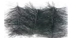
explosionsunterdrückender Einsatz (patentrechtlich geschützt), dadurch keine explosionsfähige Atmosphäre im Inneren des Behälters.
