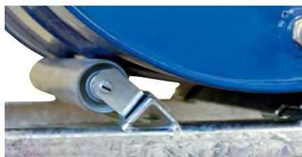
Drehbare Rollenauflage für einfaches Bewegen der Fässer
