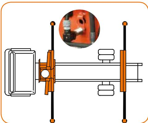
Elektr. Überwachung der Abstützweite und des Schwenkwinkels
