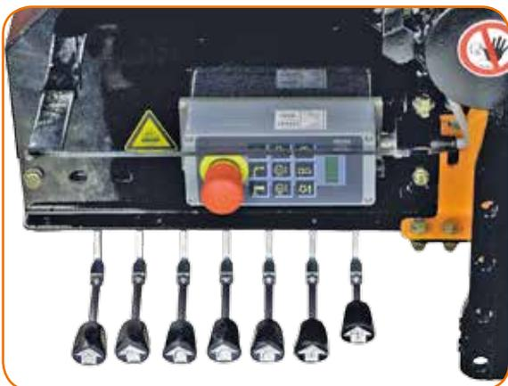
EL – HMS Handhebelsteuerung, Optional
