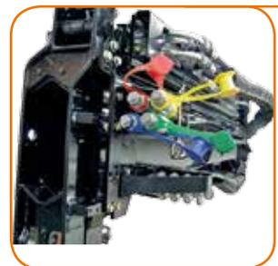
Schnellverschlusskupplungen zum schnellen Wechseln von Werkzeugen.
