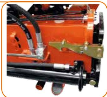
Leichte Bedienung des Sicherheitsfallhakens, für die seitliche Verriegelung des Abstützträgers.
